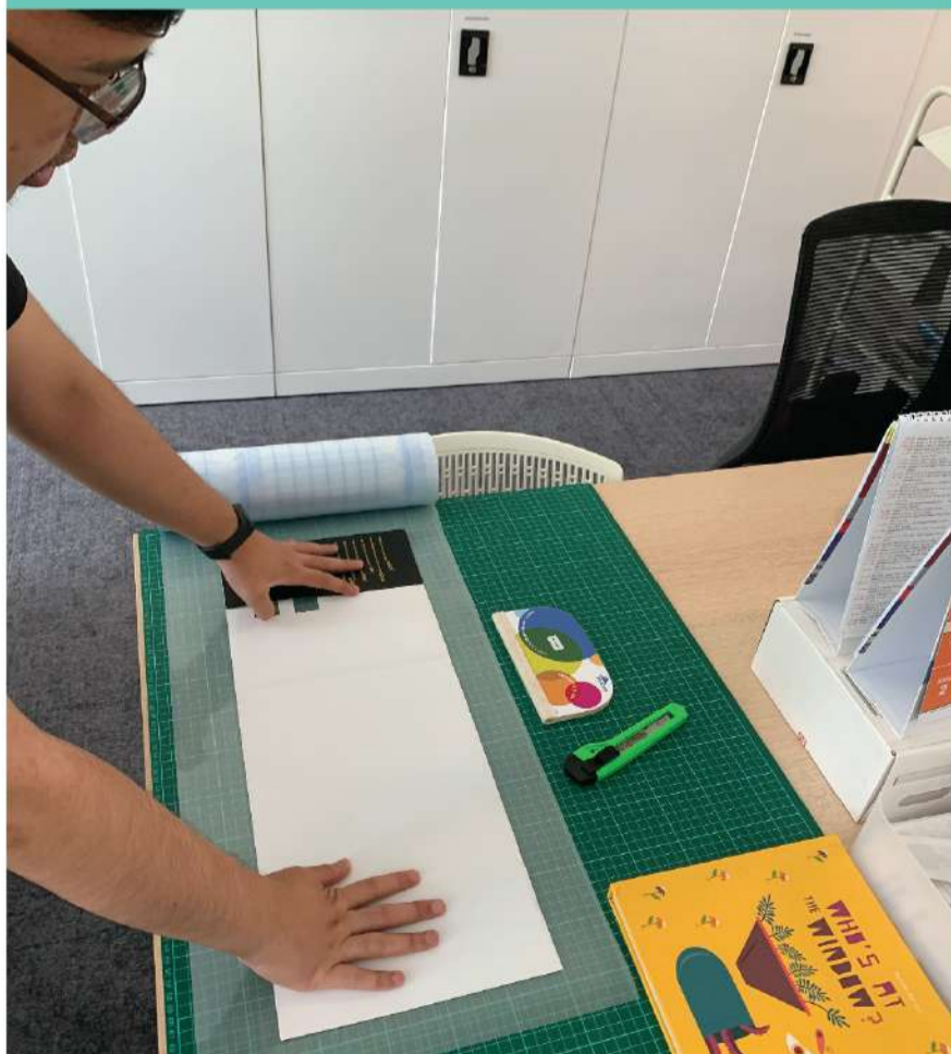
Proses Meletakkan Pelekat Pengenalan Frekuensi Radio (RFID sticker)
